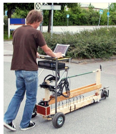
Bild 1. Messdatenerfassung mit einem luftgekoppelten Impakt-Echo Messsystem auf einer Brücken-Fahrbeläge (University of Illinois at Urbana-Champaign, [2]) (links), luftgekoppeltes Messsystem für Oberflächenwellen mit einem fahrbaren Mikrofon-Array (Lund University, [3]) (rechts)
