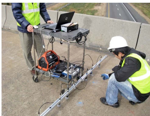
Bild 1. Messdatenerfassung mit einem luftgekoppelten Impakt-Echo Messsystem auf einer Brücken-Fahrbeläge (University of Illinois at Urbana-Champaign, [2]) (links), luftgekoppeltes Messsystem für Oberflächenwellen mit einem fahrbaren Mikrofon-Array (Lund University, [3]) (rechts)
